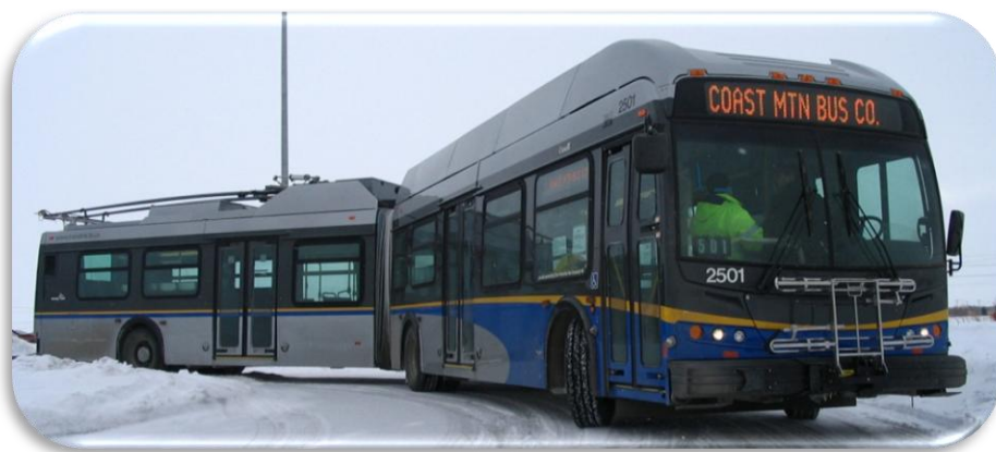
Figure 9 - Trolleybus articulé fabriqué par NewFlyer
