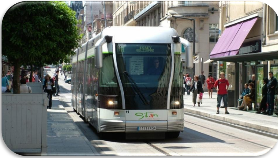
Figure 11 - Autobus électrique guidé par rail central à Nancy
