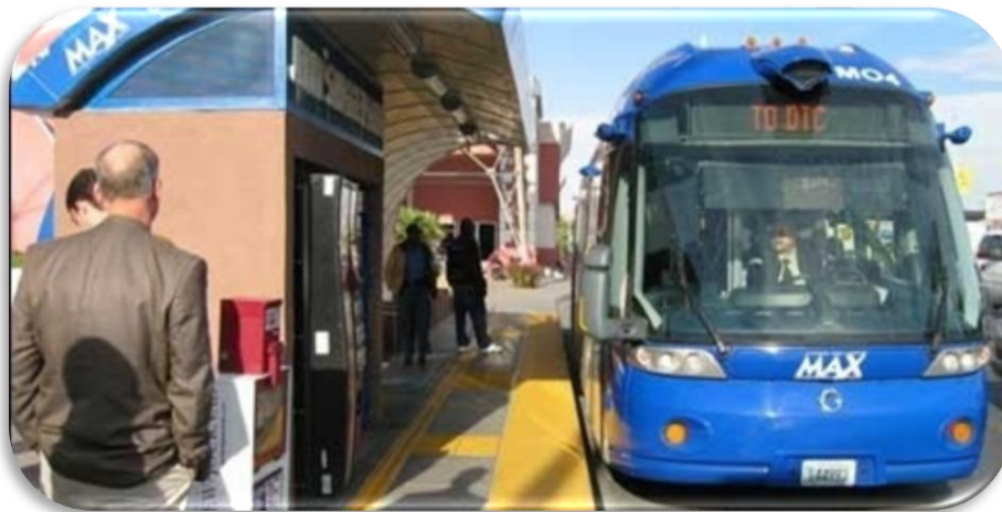
Figure 12 - Autobus à guidage virtuel à Las Vegas
